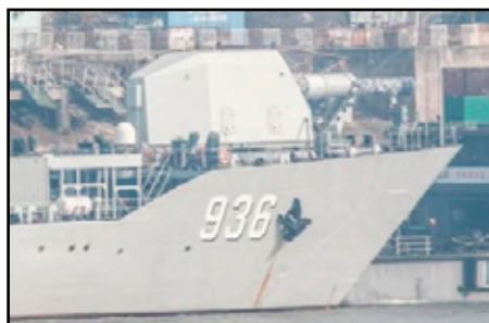
Десантный корабль «Хайяньшан» пр. 72-III с опытной рельсовой пушкой (2018). Фото: Arstechnica.net
