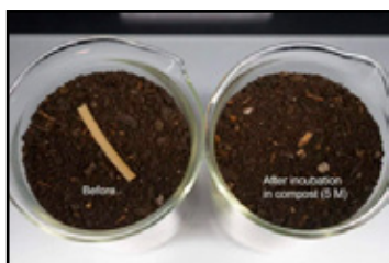
Образец пластика до (слева) и после (справа) того, как он провел пять месяцев в компосте. Фото: Han Sol Kim, newatlas.com
