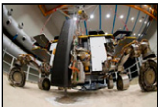
Один из важнейших инструментов ровера «Розалинд Франклин» – бур, способный проникать в грунт Марса на глубину до двух метров. На фото: испытания бура в симулированных марсианских условиях. Фото: ESA, S. Corvaja
