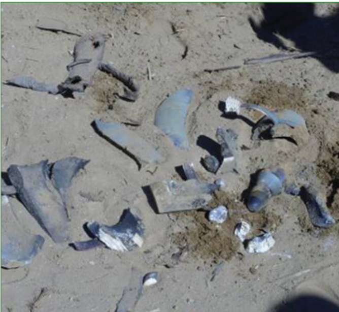
Рис. 7. 152-мм осколочно-фугасный снаряд после разрушения
