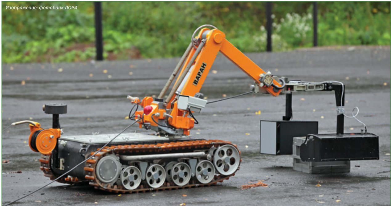
Рис. 3. Один из способов дистанционного метода уничтожения ВОП
