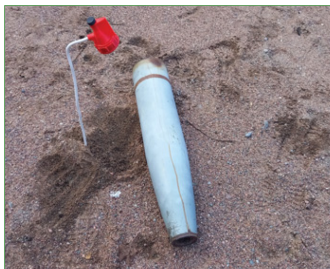
Рис. 5. Расположение разрушителя над 152-мм осколочно-фугасным снарядом
