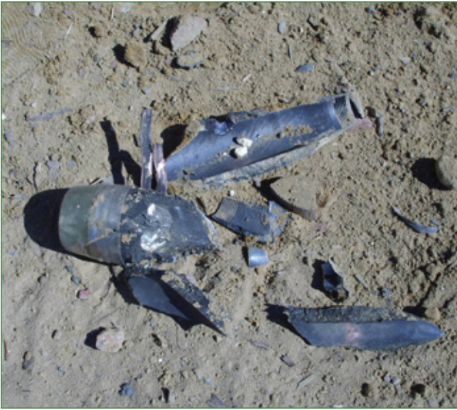
Рис. 6. 85-мм осколочно-фугасный снаряд после разрушения
