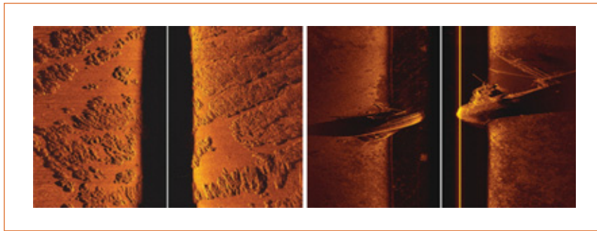
Рис. 5. Реальные изображения с гидролокатора бокового обзора
