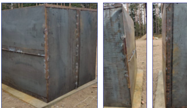
Рис. 6. Кабина после взрыва заряда массой 30 г
