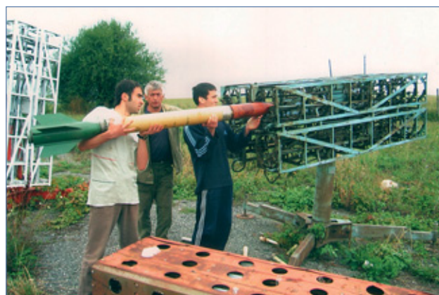
Рис. 7. Зарядка метеорологической ракеты с головной частью на основе ГРЧЭМИ для пуска по грозовому облаку
