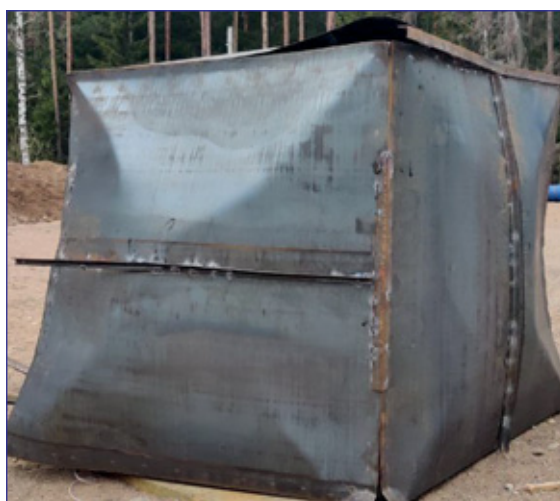
Рис. 10. Кабина после взрыва заряда массой 70 г
