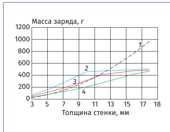
Рис. 11. Зависимость нормы загрузки от толщины стенки для полуаналитической и инженерной методик: 1 – инженерный; 2 – \sigma = 416 МПа; 3 – \sigma = 323 МПа; 4 – \sigma = 245 МПа
