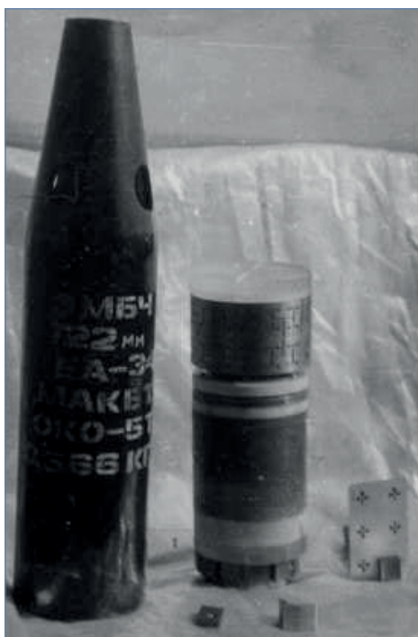
Рис. 6. Ударно-волновая ГРЧЭМИ с автономной системой энергообеспечения. Слева – головная часть метеорологической ракеты
