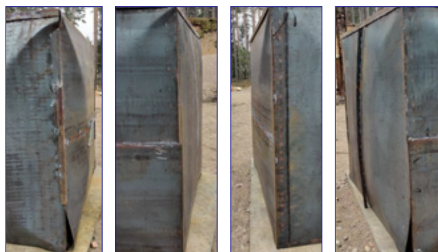
Рис. 8. Кабина после взрыва заряда массой 50 г
