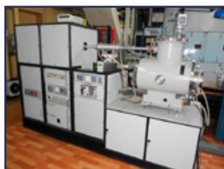
Гиротронный комплекс для высокотемпературной микроволновой обработки материалов 24 ГГц 6 кВт. Фото пресс-службы ИПФ РАН
