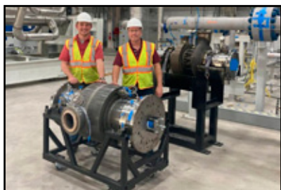
Турбина STEP, работающая на сверхкритическом углекислом газе. Фото Southwest Research Institute
