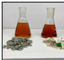
Образцы, полученные в результате пиролиза чистых полиэтилена и полипропилена с примесями. Фото пресс-службы ПНИПУ
