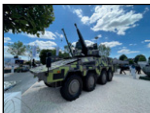
Демонстратор 30-мм зенитной самоходной установки Rheinmetall Skyranger 30 на базе колесного бронетранспортера GTK Boxer в экспозиции выставки Eurosatory 2022. Ле-Бурже, июнь 2022 года. Изображение: Rheinmetall
