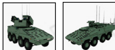
Боевая машина Flugabwehrraketenpanzer (FlaRakPz) (слева) и машина управления Feuerleitpanzer (FlaPz) (справа) перспективного германского самоходного зенитного ракетного комплекса малой дальности на базе колесного бронетранспортера GTK Boxer системы войсковой ПВО Luftverteidigung durch das Luftverteidigungssystem Nah- und Nächstbereichsschutz (LVS NNbS) Изображение: Rheinmetall
