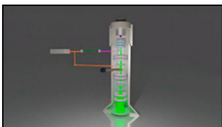
Схема экспериментальной установки. Лазер слева дает два луча, один взаимодействует с электронным лучом микроскопа, а другой (нижний луч) освещает образец. Фото: RIKEN Center for Emergent Matter Science
