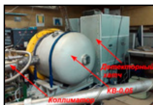
Общий вид станции «Субмикросекундной диагностики» ИЯФ СО РАН. Фото: К. Тена
