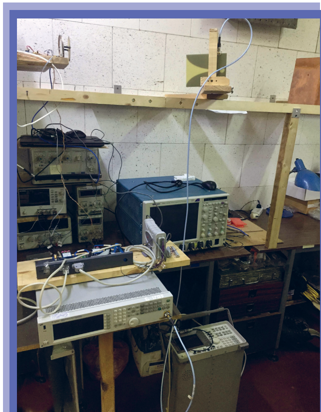
Рис. 2. Общий вид приборов и устройств установки для полунатурных испытаний на защищенность макета СКИ-радаров от воздействия активной узкополосной монохроматической помехи
