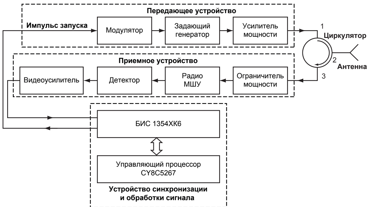
Рис. 9. Уточненная структурная схема маловысотного радара РЧ СКИ-высотомера
