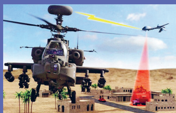
Рис. 12. Схема взаимодействия вертолета AH-64D Блок III с БЛА по тактическому каналу связи
