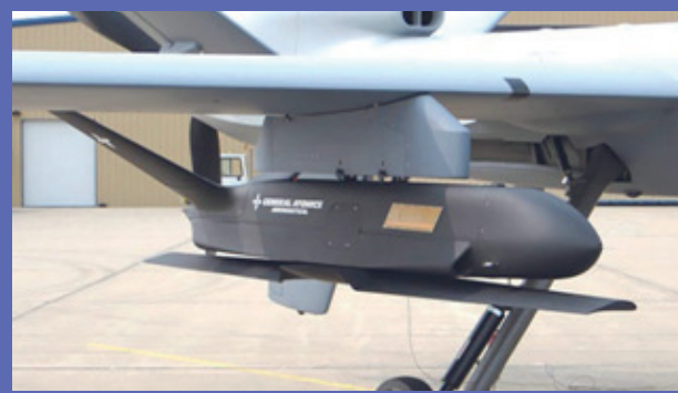
Рис. 11. Мини-БЛА «Спэрроухок» на внутреннем пилоне крыла БЛА MQ-9A «Рипер»
