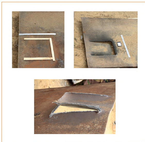
Рис. 3. Примеры выполнения работ по резке стального листа 13 мм фигурным ЗУВР
