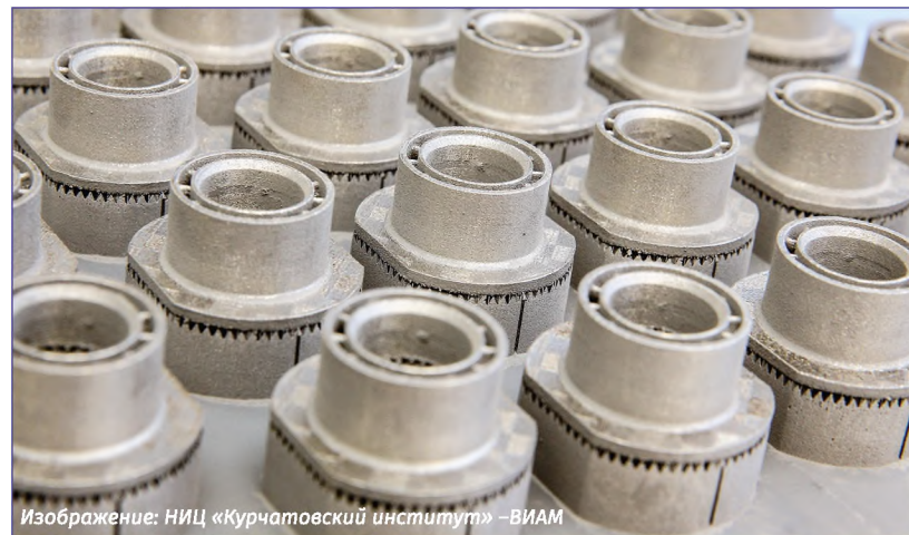
На фото: завихрители камеры сгорания двигателя ПД-14 после аддитивного технологического процесса селективного лазерного сплавления
