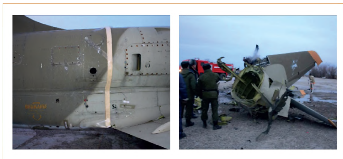
Рис. 6. Разрушение конструкции самолета с применением ЗУВР
