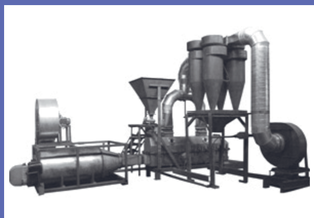
Рис. 11. Общий вид установки сушки красного фосфора в псевдокипящем слое
