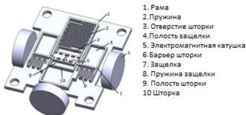
Рисунок 9 – Схематическое устройство электромагнитного ПИМ [6]
