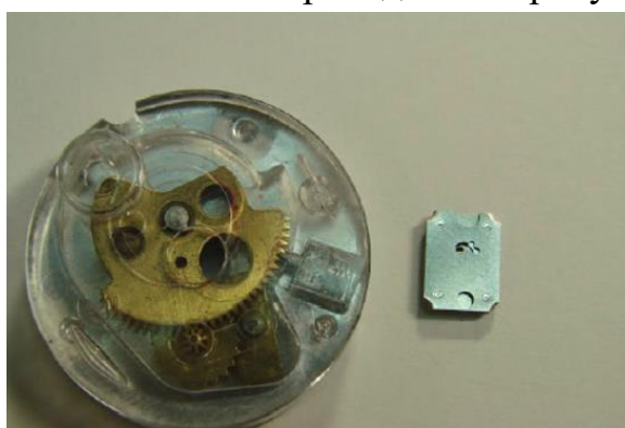
Рисунок 4 – Сравнение габаритов штатного взрывателя и взрывателя с МЭМС ПИМ [2]
