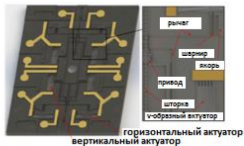
Рисунок 25 – Устройство МЭМС ПИМ с механическим декодированием [15]
