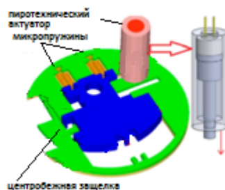
Рисунок 29 – Устройство МЭМС ПИМ на смешанных физических принципах [17]
