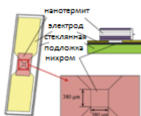
Рисунок 18 – Устройство интегрированного воспламенителя МЭМС ПИМ [12]
