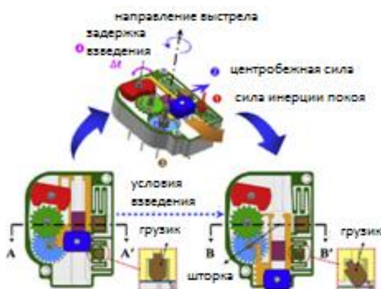
Рисунок 6 – Принцип работы инерционного ПИМ [3]
