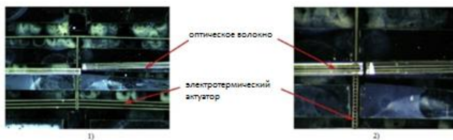
Рисунок 15 – Принцип работы электротермического ПИМ для лазерного инициирования: 1 – безопасное состояние, 2- боевое состояние [10]
